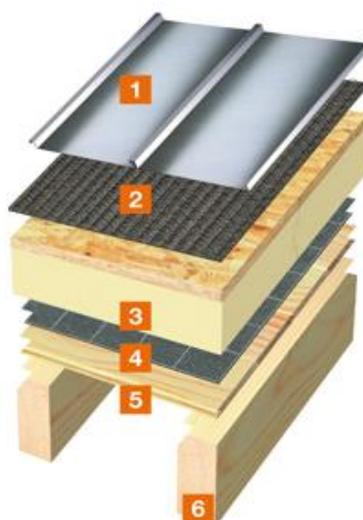
Aufbau eines Blechdaches
