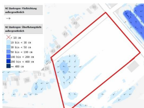
Abb. 7: Darstellung Überflutungstiefen und Fließrichtungen (ohne Maßstab) – www.geoportal.de
